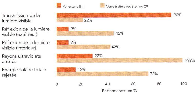
Les résultats reflètent une installation à l'intérieur d'un simple vitrage transparent de 4 mm d'épaisseur et d'un double vitrage transparent de 4mm+4mm
